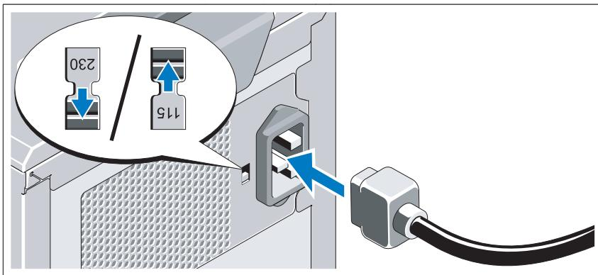
**AVISO:** Verifique se colocou a chave seletora de tensão da fonte de alimentação na voltagem que mais se aproxima da energia CA disponível na sua região.
