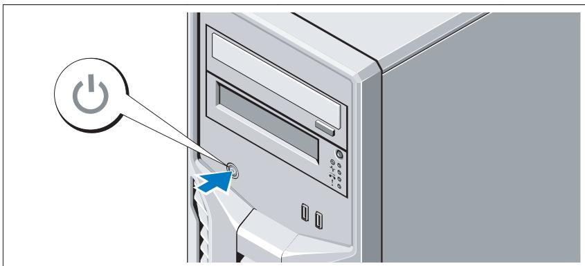
Appuyez sur le bouton de mise sous tension du système. Le voyant d'alimentation doit s'allumer.
