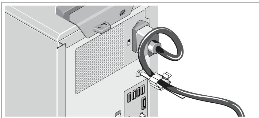
Faites une boucle comme indiqué dans l'illustration et insérez le câble d'alimentation du système dans le clip.
